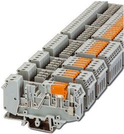
Morsetti base con presa di prova su entrambi i lati e sezionatori per guide di supporto NS 32 e NS 35/7,5, con piastra terminale, per spine ST-REL..., ST-OV... e ST-OE..., 7 poli
