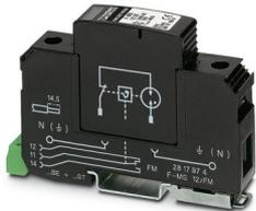
Scaricatore di sovratensioni tipo 2, costituito da elemento base con contatto FM e spina di sicurezza con spinterometro a corrente cumulativa N-PE, per montaggio su NS 35/7,5. Larghezza custodia: 17,5 mm (1TE)
