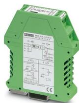
Convertitore di corrente passivo MCR, per correnti alternate sinusoidali 0..1 A AC/0..5 A AC, in uscita 0..10 V/0..20 mA
