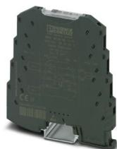
Duplicatore di segnale a 4 vie, per la duplicazione e la separazione galvanica di segnali analogici con connessione a vite, segnale in ingresso: 4 mA ... 20 mA, segnale in uscita: 2 x 4 mA ... 20 mA
