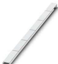
Nastro Zack, Striscia, bianco, in bianco, siglabile con: CMS-P1-PLOTTER, PLOTMARK, tipo di montaggio: bloccaggio, per morsetti con spessore: 18 mm, Numero dei cartellini singoli: 5, altezza del campo di testo: 5 mm, larghezza del campo di testo: 18 mm
