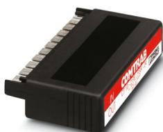
Connettore LSA-PLUS (COMTRAB CT 10) con protezione bassa/elevata contro le sovratensioni e resistenza di disaccoppiamento per 10 circuiti di segnali a potenziale di terra zero. Tensione nominale: 24 V DC. Esecuzione: 10 fili doppi
