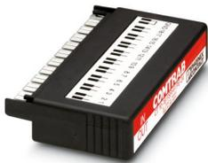
Connettore LSA-PLUS (COMTRAB CT 10) con protezione bassa/elevata contro le sovratensioni per 18 linee di segnali - GND e protezione primaria GND - PE. Tensione nominale: 24 V DC. Esecuzione: 10 fili doppi
