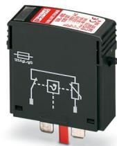
Scaricatore di sovratensioni tipo 2 con varistore di potenza per elemento base VAL-MS, controllato termicamente, segnalazione ottica di guasto. Esecuzione: 120 V AC
