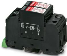
Scaricatore di sovratensione costituito da elemento base a 2 canali con contatto FM e spine di protezione innestate in serie da varistore e spinterometro a gas.
