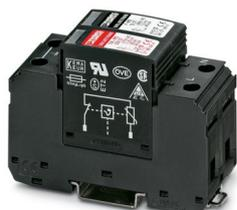
Scaricatore di sovratensioni per sistemi di alimentazione a 3 conduttori (L1, N, PE), costituito da elemento base e spina di sicurezza, per montaggio su NS 35.
