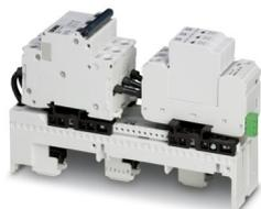
Combinazione di protezione contro le sovratensioni tipo 2 e prefusibile scaricatore, con monitoraggio dello scaricatore, in abbinamento all'indicazione di stato e al contatto FM. Esecuzione: sistema a 4 conduttori (L1, L2, L3, PE), montaggio su serie da 60 mm (sistema di barre conduttrici)
