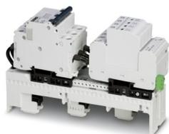
Combinazione di protezione contro le sovratensioni tipo 2 e prefusibile scaricatore, con monitoraggio dello scaricatore, in abbinamento all'indicazione di stato e al contatto FM. Esecuzione: sistema a 5 conduttori (L1, L2, L3, N, PE), montaggio su serie da 60 mm (sistema di barre conduttrici)
