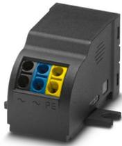
Scaricatore tipo 3 per il montaggio universale in prese, canaline portautenze, installazioni alla base o dirette al terminale. Circuito controllato termicamente, segnalazione acustica di guasto. Installazione in cablaggi a linea di derivazione o di tipo passante. Esecuzione: 230 V AC
