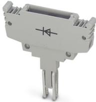
Spina portacomponenti con diodo universale, per componenti a 2 poli da montare sul morsetto base, altezza: 19 mm, colore: grigio
