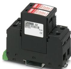
Scaric. di corr. atmosf./sovratensioni universali a innesto formati da varistori per applicaz. da -48VDC, nelle quali il cond. di neutro (polo pos.) è collegato a massa, senza valutaz. del rischio per le classi di protez. contro i fulmini III e IV, con contatto FM.
