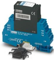
Protezione contro le sovratensioni, composta da spina estraibile ed elemento base, con indicatore di stato integrato a più livelli sul modulo, per un circuito del segnale Ex-i a potenziale zero a 2 fili, compatibile con HART. Utilizzabile in circuiti di sicurezza fino a SIL 3.
