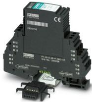
Protezione contro le sovratensioni, costituita da spina estraibile ed elemento base, con indicatore di stato integrato a più livelli sul modulo per cinque fili del segnale. Per applicazioni HF e interfacce di telecomunicazione senza tensione di alimentazione (fino a 90 MBit/s). Utilizzabile in circuiti di sicurezza fino a SIL 3.
