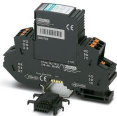
Limitatore di sovratensione, costituito da connettore ed elemento base, con indicatore di stato integrato a più livelli sul modulo, per la protezione dei fili doppi delle interfacce analogiche e digitali per telecomunicazioni (VDSL fino a 50 MBit/s, su tratti brevi (< 300 m) fino a 100 MBit/s). Utilizzabile in circuiti di sicurezza fino a SIL 3.
