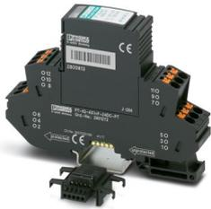
Protezione contro le sovratensioni, composta da spina estraibile ed elemento base, con indicatore di stato integrato a più livelli sul modulo per quattro fili di segnale con potenziale di riferimento comune. Messa a terra indiretta mediante scaricatore a gas. Utilizzabile in circuiti di sicurezza fino a SIL 3.
