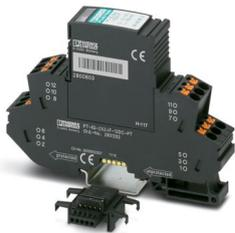
Protezione contro la sovratensione, composta da spina estraibile ed elemento base, con indicatore di stato integrato a più livelli sul modulo per due circuiti di segnale con potenziale di terra zero a 2 fili. Messa a terra indiretta mediante scaricatore a gas. Utilizzabile in circuiti di sicurezza fino a SIL 3.
