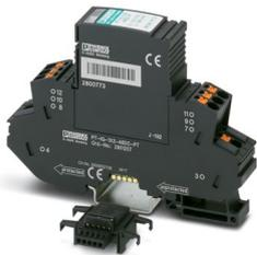
Protezione contro la sovratensione, composta da spina estraibile ed elemento base, con indicatore di stato integrato a più livelli sul modulo per un circuito del segnale libero da potenziale di terra a 2 fili. Utilizzabile nei circuiti di sicurezza fino a SIL 3.
