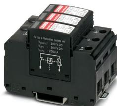
Scaricatore di corrente atmosferica / di sovratensione per sistemi fotovoltaici a tensione continua a 2 poli isolati e collegati a terra 600 V DC, per montaggio su guida DIN, elemento di base a 3 poli, tre elementi di protezione a innesto monitorati termicamente, segnalazione di stato su ogni connettore.
