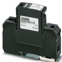
Scaricatore di corrente atmosferica/di sovratensioni, costituito da elemento base e spina di sicurezza con spinterometro a corrente cumulativa N-PE, per montaggio su NS 35/7,5. Largh. custodia: 17,5 mm (1TE)
