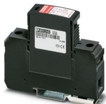
Scaricatore di corrente atmosferica/di sovratensioni ad innesto universale formato da varistore per reti di alimentazione monofase con N e PE comune (sistema a 2 conduttori: L1, PEN).
