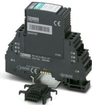
Protezione contro le sovratensioni, costituita da spina estraibile ed elemento base, con indicatore di stato integrato a più livelli sul modulo per tre fili del segnale con potenziale di riferimento comune. Messa a terra indiretta mediante scaricatore a gas. Per applicazioni HF e interfacce di telecomunicazione senza tensione di alimentazione (fino a 90 MBit/s). Utilizzabile in circuiti di sicurezza fino a SIL 3.
