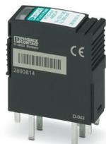
Spina di protezione contro le sovratensioni con indicatore di stato a più livelli integrato sul modulo per quattro fili di segnale con potenziale di riferimento comune. Tensione nominale: 48 V DC
