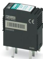
Spina di protezione contro le sovratensioni con indicatore di stato a più livelli integrato sul modulo per due circuiti di segnale a potenziale zero a 2 fili. Tensione nominale: 5 V DC
