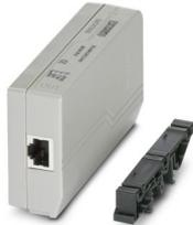
Protezione contro le sovratensioni per reti dati fino a 1 GBit/s. Utilizzo in Ethernet, Power over Ethernet (PoE, Mode A e Mode B), Token Ring, ISDN e DS1. Adattatore RJ45 con linea di messa a terra separata e piedino di fissaggio per guide di supporto NS 35.
