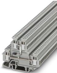
Minimorsetto passante, La corrente massima è determinata dal diodo. Integrato: diodo 1N 4007, tensione di blocco: 1300V, corrente limite permanente: 0,5A., con diodo integrato, tensione nominale: 500 V, corrente nominale: 0,5 A, 1. e 2. piano, tipo di connessione: Connessione a vite, Sezione di dimensionamento: 2,5 mm<sup>2</sup>, sezione: 0,2 mm<sup>2</sup> - 4 mm<sup>2</sup>, montaggio: NS 15, NS 35/7,5, NS 35/15, colore: grigio
