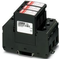
Scaricatore di corrente atmosferica/di sovratensioni ad innesto universale formato da varistore per reti di alimentazione trifase con N e PE comune (sistema a 4 conduttori: L1, L2, L3, PEN).
