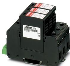
Scaricatore di corrente atmosferica/di sovratensioni ad innesto universale formato da varistore per reti di alimentazione trifase con N e PE comune (sistema a 4 conduttori: L1, L2, L3, PEN), con contatto FM.
