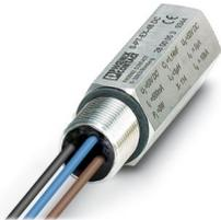
Protezione contro la sovratensione per un circuito del segnale libero da potenziale di terra nel modulo a vite con grado di protezione IP67 per teste di sensore, connessione M20 x 1,5. Testata secondo i tipi di protezione per zone a potenziale rischio di esplosione Ex d / Ex tD / Ex ia IIC / Ex iaD. Adatto per l'utilizzo nel sistema di bus di campo secondo il concetto FISCO. Utilizzabile nei circuiti di sicurezza fino a SIL 3.
