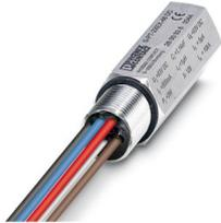
Protezione contro la sovratensione per due circuiti del segnale con potenziale di terra zero nel modulo a vite con grado di protezione IP67 per teste di sensore, connessione M20 x 1,5. Testata secondo i tipi di protezione per zone a potenziale rischio di esplosione Ex d / Ex tD / Ex ia IIC / Ex iaD. Adatta per l'utilizzo nel sistema di bus di campo secondo il concetto FISCO. Utilizzabile in circuiti di sicurezza fino a SIL 3.
