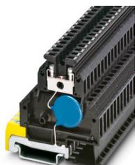
Morsetto componibile con condensatore interferenze tra morsetti e guida, attacco PE separato, capacità: 3,3 nF, montaggio su NS 35/7,5, spessore morsetto: 6,2 mm, altezza: 69 mm
