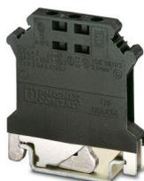
Morsetto per potenziale di riferimento, In caso di affiancamento con morsetti passanti dal profilo identico, in presenza di tensioni di isolamento 690 V, occorre impiegare una piastra terminale., numero di connessioni: 2, numero poli: 1, tipo di connessione: Connessione a vite, Sezione di dimensionamento: 4 mm<sup>2</sup>, sezione: 0,2 mm<sup>2</sup> - 4 mm<sup>2</sup>, tipo di montaggio: NS 35/7,5, NS 35/15, NS 32, colore: nero
