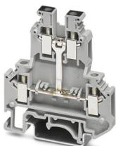
Morsetto a due piani, con ripartitore di potenziale, tensione nominale: 500 V, corrente nominale: 32 A, tipo di connessione: Connessione a vite, Sezione di dimensionamento: 4 mm<sup>2</sup>, sezione: 0,2 mm<sup>2</sup> - 4 mm<sup>2</sup>, tipo di montaggio: NS 35/7,5, NS 35/15, NS 32, colore: grigio
