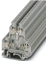
Componente morsetto componibile, La corrente massima è determinata dal diodo. Integrato: diodo 1N 4007, tensione di blocco: 1300V, corrente limite permanente: 0,5A., con diodo integrato, corrente nominale: 0,5 A, tipo di connessione: Connessione a vite, 1. e 2. piano, Sezione di dimensionamento: 4 mm<sup>2</sup>, sezione: 0,2 mm<sup>2</sup> - 4 mm<sup>2</sup>, tipo di montaggio: NS 35/7,5, NS 35/15, NS 32, colore: grigio
