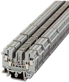
Morsetti base con presa di prova su entrambi i lati e duplice connessione con stesso potenziale per guide di supporto NS 32 e NS 35/7,5, con piastra terminale, per spine ST-REL..., ST-OV... e ST-OE...
