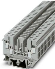
Morsetto sezionatore, Corrente e tensione sono determinate dalla spina impiegata., tensione nominale: 400 V, corrente nominale: 16 A, tipo di connessione: Connessione a vite, Sezione di dimensionamento: 4 mm<sup>2</sup>, sezione: 0,2 mm<sup>2</sup> - 6 mm<sup>2</sup>, montaggio: NS 35/7,5, NS 35/15, NS 32, colore: grigio
