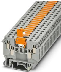
Morsetto con sezionatore a coltello, con viti per prese di prova per l'alloggiamento di spine di prova, tensione nominale: 630 V, corrente nominale: 16 A, 1. piano, tipo di connessione: Connessione a vite, Sezione di dimensionamento: 4 mm<sup>2</sup>, sezione: 0,2 mm<sup>2</sup> - 6 mm<sup>2</sup>, montaggio: NS 35/7,5, NS 35/15, NS 32, colore: grigio
