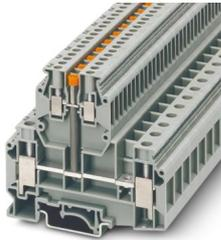
Morsetto a due piani, con ripartitore di potenziale, tensione nominale: 500 V, corrente nominale: 57 A, tipo di connessione: Connessione a vite, Sezione di dimensionamento: 10 mm<sup>2</sup>, sezione: 0,5 mm<sup>2</sup> - 16 mm<sup>2</sup>, tipo di connessione: Connessione a vite, 2. piano, Sezione di dimensionamento: 2,5 mm<sup>2</sup>, sezione: 0,2 mm<sup>2</sup> - 4 mm<sup>2</sup>, tipo di montaggio: NS 35/7,5, NS 35/15, NS 32, colore: grigio
