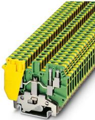
Morsetti comp. per conduttori terra, connessione doppia su ogni lato, numero di connessioni: 4, numero poli: 1, tipo di connessione: Connessione a vite, 1. piano, sezione:  $0,2 \text{ mm}^2 - 6 \text{ mm}^2$ , tipo di fissaggio: Piedino PE con vite di fissaggio M3, tipo di montaggio: NS 35/7,5, NS 35/15, NS 32, colore: giallo-verde
