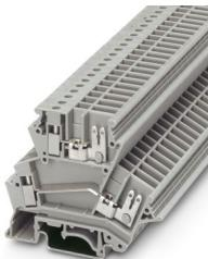
Morsetto passante, tensione nominale: 400 V, corrente nominale: 20 A, 1. e 2° piano, collegamento a sinistra, tipo di connessione: Connessione a vite, Sezione di dimensionamento: 4 mm<sup>2</sup>, sezione: 0,2 mm<sup>2</sup> - 4 mm<sup>2</sup>, tipo di connessione: Connessione Faston, montaggio: NS 35/7,5, NS 35/15, NS 32, colore: grigio
