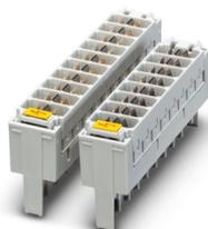
Caricatore di protezione primaria CT per l'alloggiamento di 20 scaricatori a gas a due elettrodi di forma a H, non equipaggiato. Esecuzione: 10 conduttori doppi
