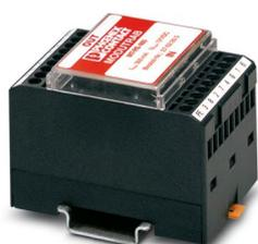
Modulo guida con protezione fine dalle sovratensioni primaria e fine per interfaccia RS-485 per il montaggio su NS 35/7,5, larghezza custodia: 50 mm
