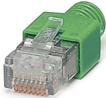
Connettore RJ45, tipo: RJ45, grado di protezione: IP20, numero poli: 8, 1 Gbit/s, CAT5 (IEC 11801:2002), materiale: Plastica, tipo di connessione: Connessione a crimpare, sezione di connessione: AWG 26- 24, uscita cavo: diritto, colore: grigio, Ethernet
