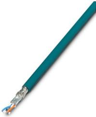
In metri, Cavo d'installazione, Ethernet CAT5 (100 MBit/s), schermata, PUR senza alogenati, azzurro mare RAL 5021, 4-conduttori (2x2xAWG26/7, SF/UTP), colore conduttore singolo: bianco/arancione-arancione, bianco/verde-verde, lunghezza cavo: Ingresso libero (1,0... 1000,0 m)
