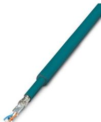
Cavo CAT5-SF/UTP (J-02YS(ST)C HP 2 x 2 x 24 AWG) robusto cavo, 2 x 2 x 0,22 mm<sup>2</sup>, conduttori rigidi, schermati, guaina esterna: diametro 7,8 mm, guaina interna: diametro 5,75 mm ± 0,15 mm
