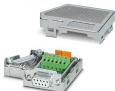
Connettore D-SUB, connettore femmina a 9 poli, due uscite cavo a 35° su una fila di morsetti, sistema bus: CAN, CANopen®, SafetyBus-P fino a 1 MBit/s, resistenza di terminazione attivabile tramite interruttore a scorrimento, piedinatura: 2, 3, 7; morsetti a vite
