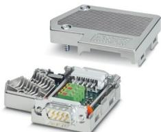
Connettore D-SUB, a 9 poli, spina, uscita cavo a 35°, sistema bus: PROFIBUS DP fino a 12 MBit/s con connettore femmina Pg-D-SUB per il collegamento di un dispositivo di programmazione, resistenza di terminazione attivabile tramite interruttore a scorrimento, piedinatura: 3, 5, 6, 8; morsetti di collegamento a molla
